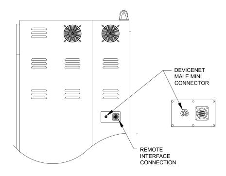
Figure 41: DeviceNet male mini connector plug
